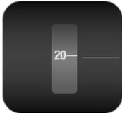
1. • Die Farbtemperaturen werden durch 100 geteilt angezeigt ( $2000\text{ K}/100 = 20$ ,  $3000\text{ K}/100 = 30$  usw.), um die Lesbarkeit und präzise Kennzeichnung auf dem Zifferblatt zu gewährleisten
